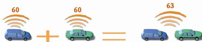
Figure 1 : Addition des niveaux de bruit (en dB)
